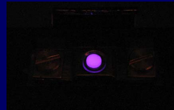
Świecenie detektora TL z LiF:Mg, Ti w czytniku TL.
