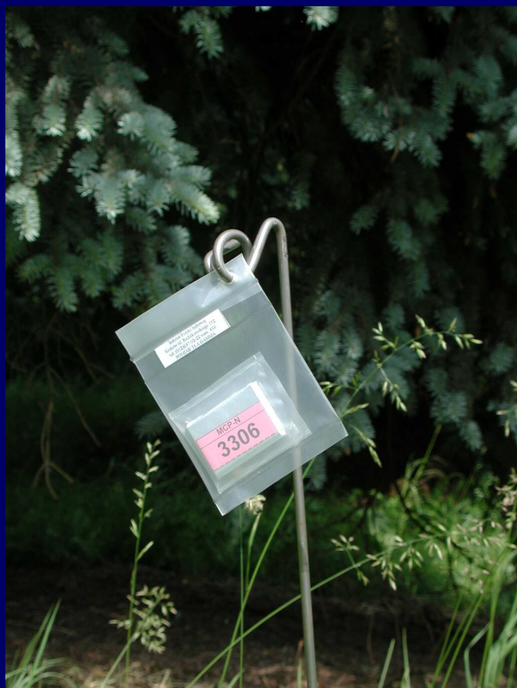
Fot. Dawkomierz DS-86 w punkcie środowiskowym i elementy składowe
