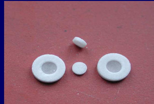
Miniaturowe (fi2mm) detektory z ^6\text{LiF:Mg,Ti}
