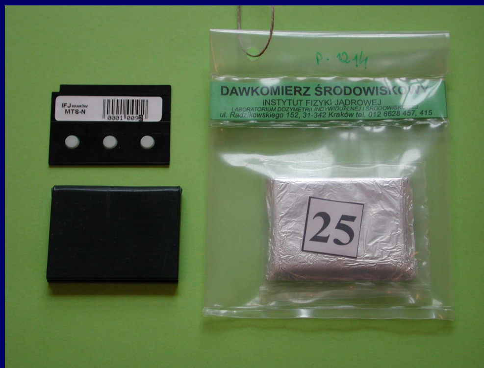
Fot. Dawkomierz DS-86 w punkcie środowiskowym i elementy składowe
