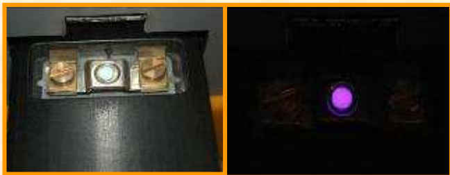
Świecenie detektora TL z \text{LiF:Mg, Ti} w czytniku TL.
