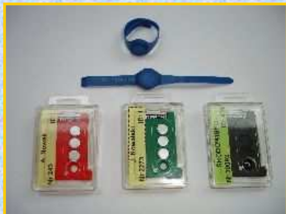
Dawkomierze (DI-02, DS-04, PI-01) odczytywane w czytnikach automatycznych DOSACUS RADOS.
