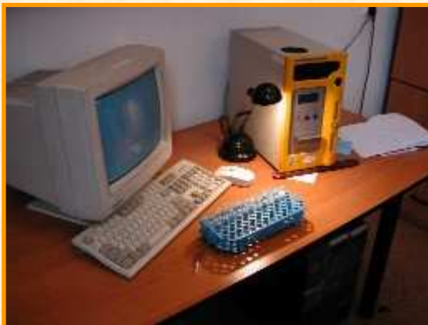
Laboratoryjny czytnik TLD RA-94 (Microlab)
